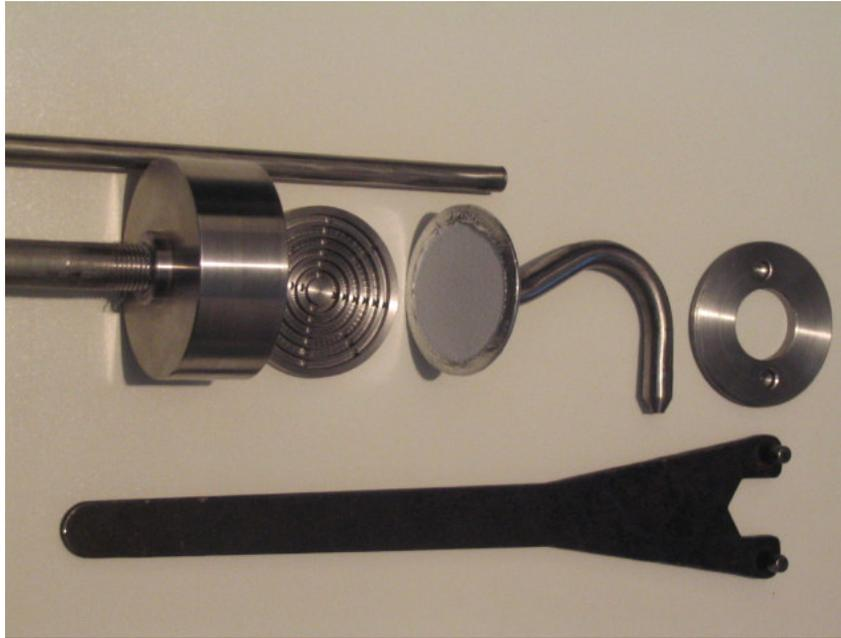
**Figura 29 - Preparação da sonda e boquilha.**
