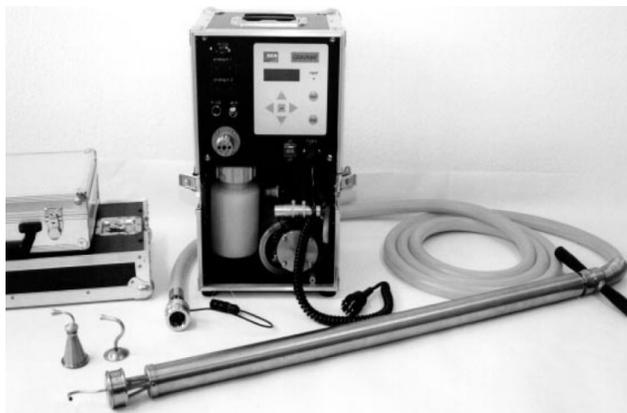
**Figura 11 - Equipamento Isocinético (C). Fonte Catálogo do Equipamento.**
