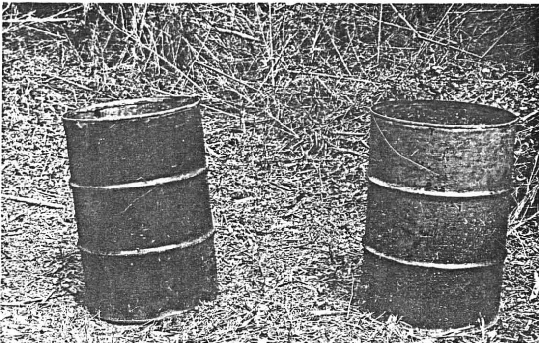
Figura 5: Tambores de duzentos litros contendo corpos de prova de bambu imersos em solução aquosa a 2% e a 5% de preservativo à base de CCB.
