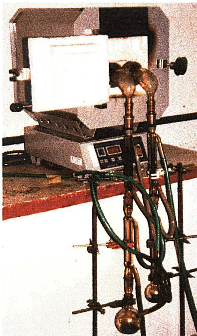
FIGURA 14 – PROCESSO DE CARBONIZAÇÃO EM FORNO MUFLA PROGRAMÁVEL COM SISTEMA DE CONDENSAÇÃO ACOPLADO AOS TUBOS DE DESTILAÇÃO.
