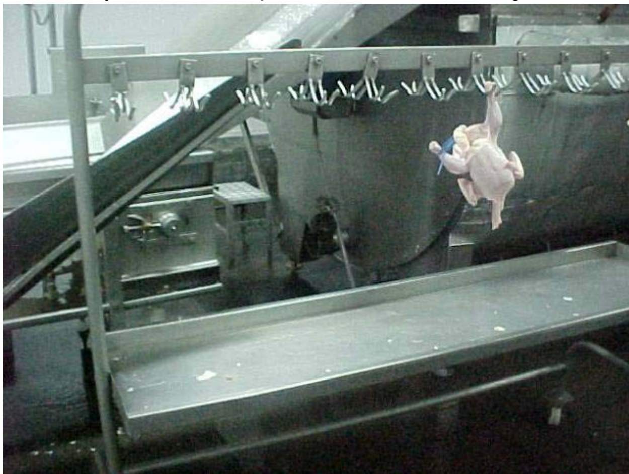
Foto 6 – Gotejamento da carcaça para eliminação do excesso de água
