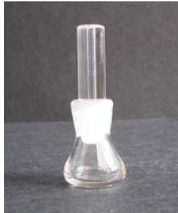
FIGURA 3.2 Picnômetro usado para determinação da densidade relativa (1 mL de capacidade).
