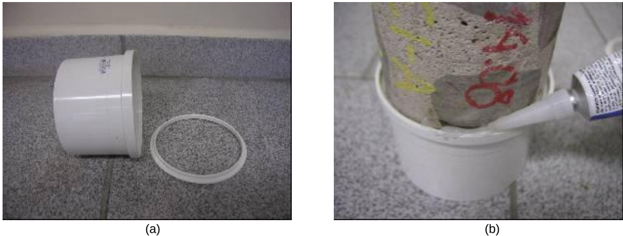
FIGURA 15 - LUVA SIMPLES DE ESGOTO COM A ALÇA DE ENGATE CORTADA (A). PREENCHIMENTO DOS ESPAÇOS E FIXAÇÃO COM COLA DE SILICONE TRANSPARENTE (B).
