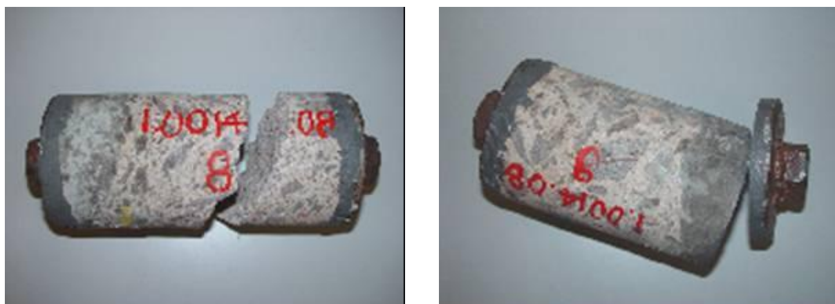
FIGURA 35 - ENSAIO DE RESISTÊNCIA DE ADERÊNCIA. RUPTURA NO SUBSTRATO (A). RUPTURA LIGAÇÃO ENTRE O CORPO DE PROVA E A PLACA METÁLICA (B)
