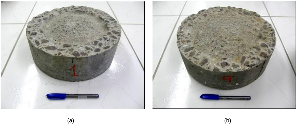
FIGURA 52 – FOTOGRAFIA DO CP APÓS O ENSAIO DE ABRASÃO CONSTITUÍDO PELO SUBSTRATO E MR. CONCRETO DE REFERÊNCIA (A). CONCRETO COM ADIÇÃO DE PEBD NO TEOR DE 5% (B)
