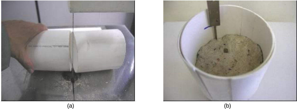
FIGURA 19 - CORTE NO COMPRIMENTO (A). MARCAÇÃO DA ALTURA DE CONCRETAGEM (B).
