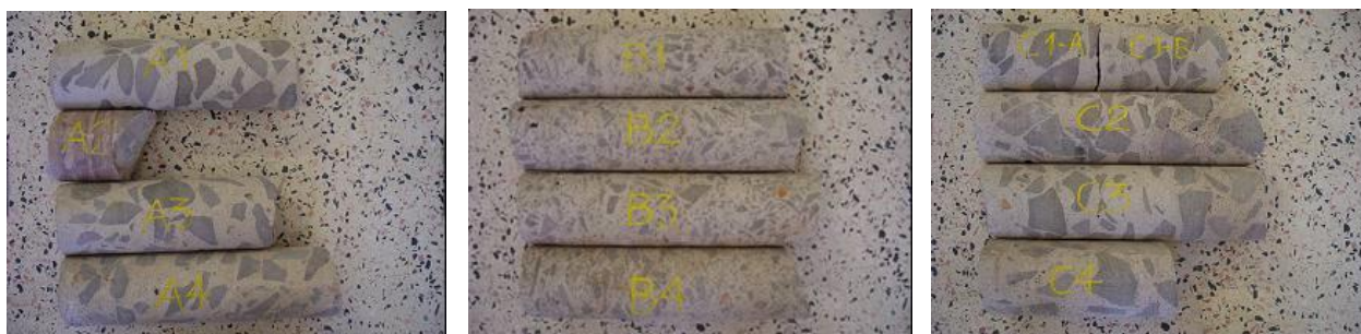
FIGURA 34 - TESTEMUNHOS DE CONCRETO DA UHE MOURÃO.
