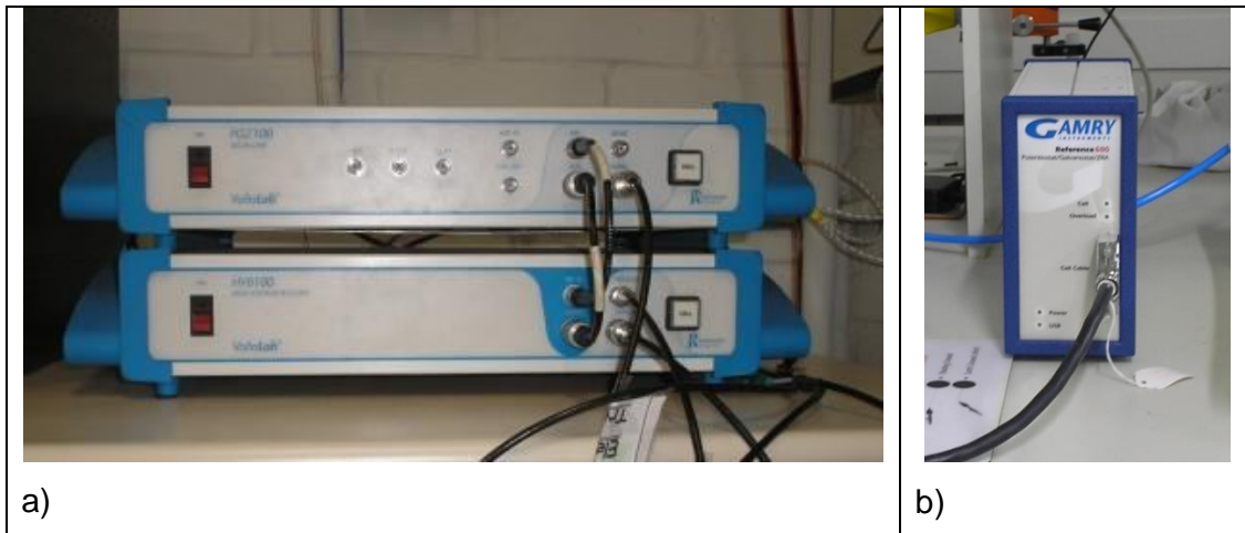
Figura 7 – (a) Potenciostato/Galvanostato Voltalab 10 (PGZ 100) ligado ao High Voltage Booster (HVB 100) e (b) potenciostato/galvanostado/ZRA Reference 600 da Gamry Instruments.
