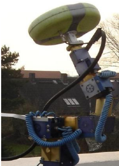
FIGURA 21 - CALIBRAÇÃO ABSOLUTA EM CAMPO DE FORMA AUTOMATIZADA FONTE: FREIBERGER JUNIOR (2007)
