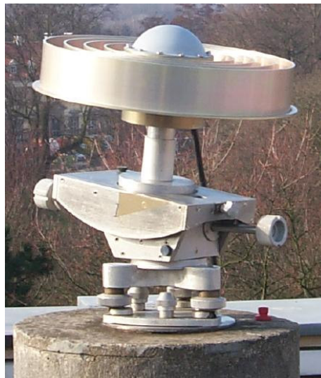
FIGURA 20 - CALIBRAÇÃO ABSOLUTA EM CAMPO DE FORMA MANUAL (B) FONTE: FREIBERGER JUNIOR (2007)
