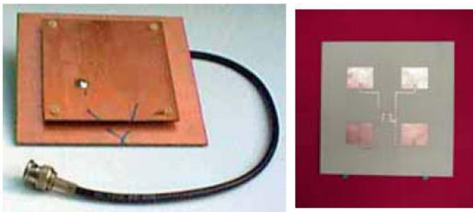
FIGURA 10 - ANTENA PATCH E ESTRUTURA INTERNA FONTE: FRANZ (2007)
