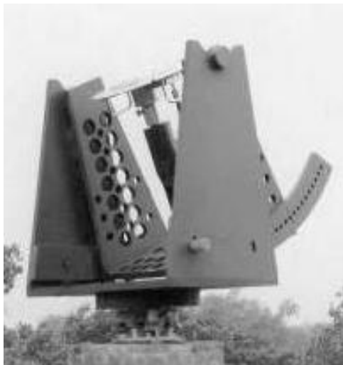
FIGURA 19 - CALIBRAÇÃO ABSOLUTA EM CAMPO DE FORMA MANUAL(A) FONTE: WÜBBENA et al., (1996)
