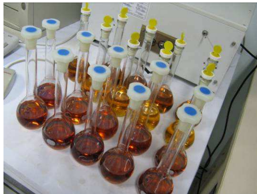
Figura 9. Amostras de misturas formuladas com óleo diesel e biodiesel. Em primeiro plano estão misturas contendo até 10% de biodiesel, em volume. Ao fundo, aparecem misturas que têm percentuais superiores de biodiesel.
