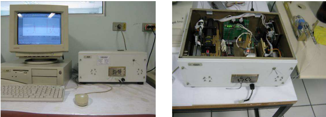
Figura 8. Aspectos do analisador de infravermelho usado na obtenção dos espectros FTIR-ATR.
