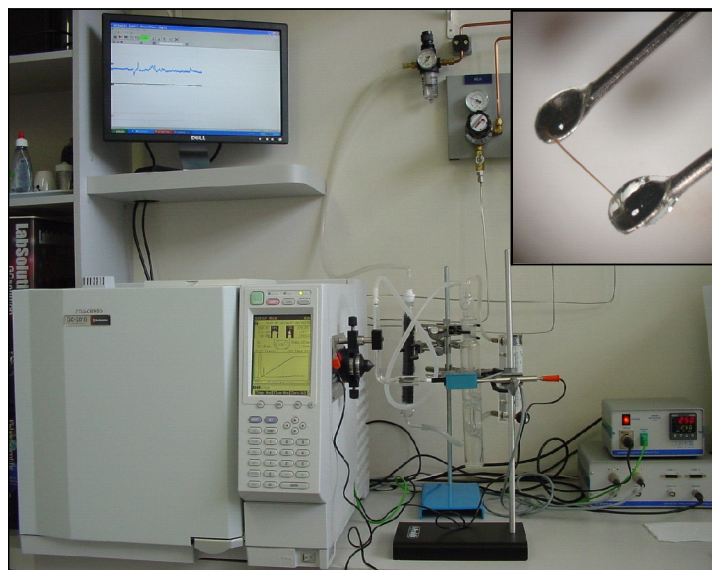
Figura 1.3 Cromatógrafo em fase gasosa acoplado a eletroantenoógrafo (GC-EAD). No destaque antena fixada entre dois eletrodos (Fonte: arquivo do Laboratório de Semioquímicos-UFPR).
