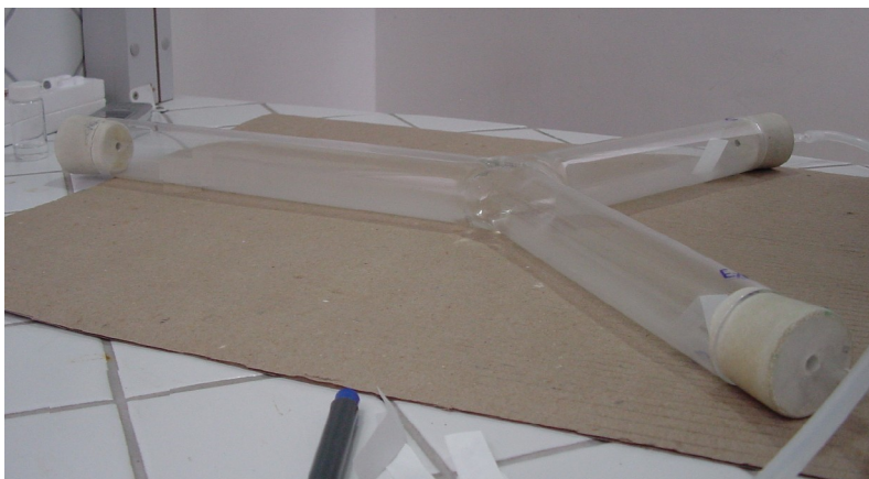
Figura 4.3 Fotografia do olfatômetro de vidro de dupla escolha do tipo Y (Fonte: arquivo do Laboratório de Semioquímicos-UFPR).
