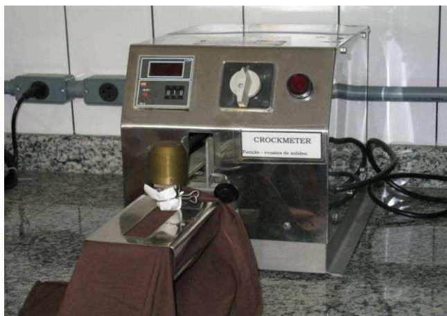
Figura 15. Aparelho Crockmeter para determinação da solidez à fricção
