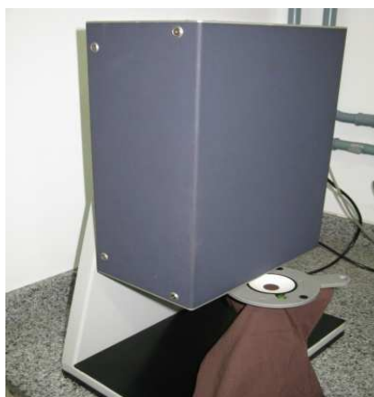
Figura 18. Espectrofotômetro de Remissão com funções para determinação da diferença de cor, desvio de tonalidade, desvio de pureza e desvio de claridade entre tecidos
