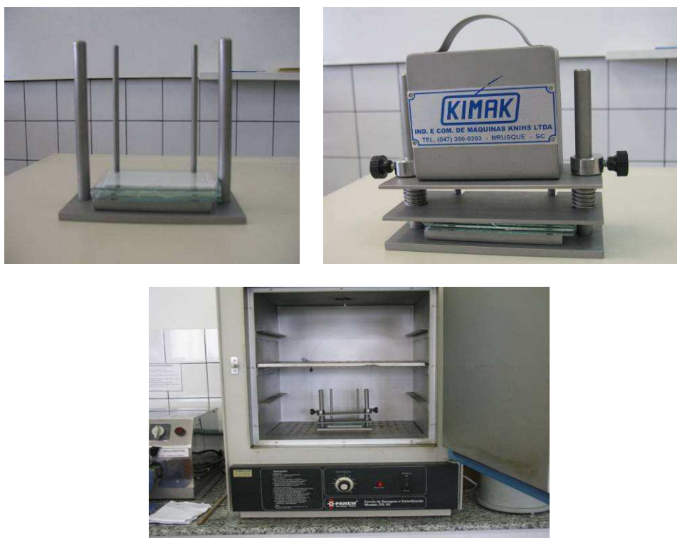
Figura 16. Detalhes da montagem dos corpos de prova no Perspirômetro utilizado na avaliação da solidez ao suor ácido e alcalino
