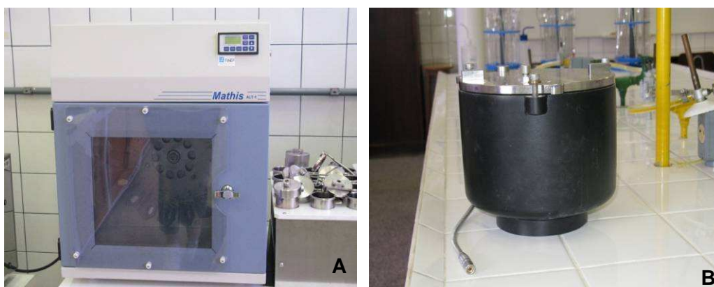
Figura 11. Máquina de Tingimento Mathis (A) e detalhe do caneco de 5 litros (B) Fonte: (a autora, 2009)
