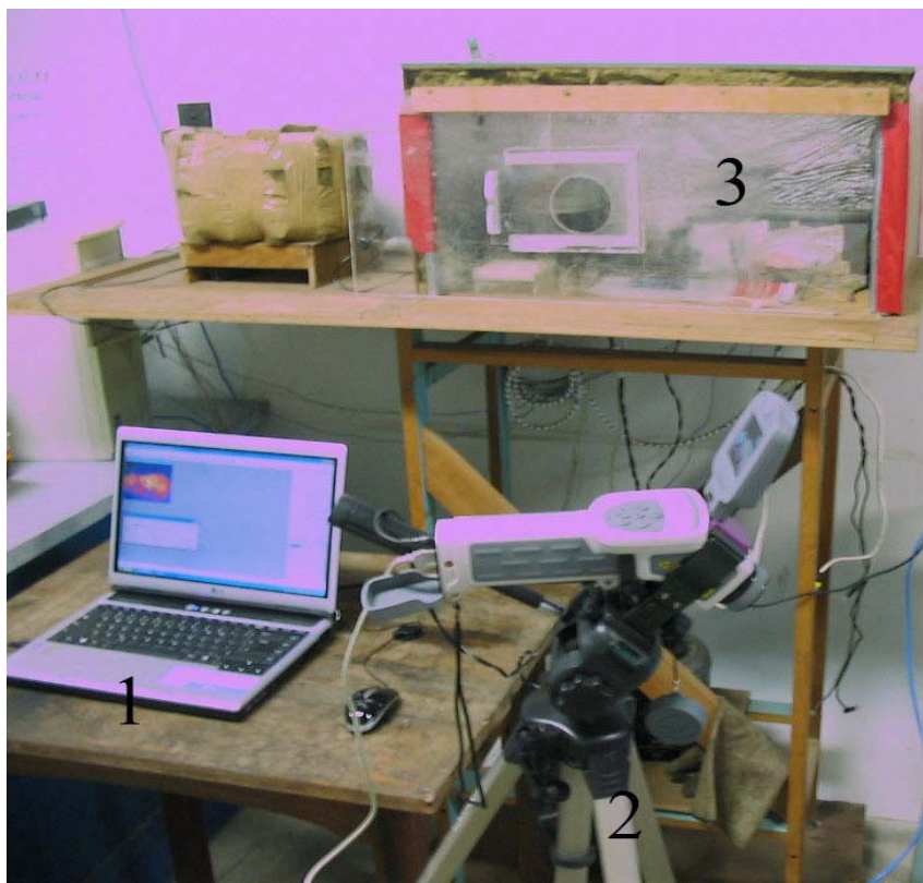
FIGURA 9 - TERMOVISOR E SEU TRIPÉ (2) ACOPLADO AO COMPUTADOR (1) NO CENTRO OBSERVA-SE O AMBIENTE DE UMIDADE E TEMPERATURA CONTROLADOS (3)
