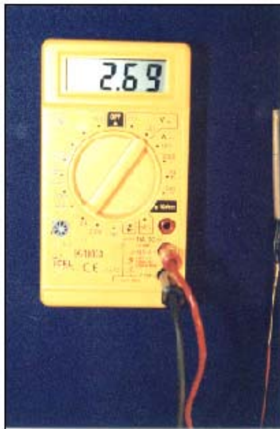
FIGURA 2 – SENSOR DE TEMPERATURA CONECTADO A UM MULTÍMETRO UTILIZADO NA MONITORAÇÃO AMBIENTAL
