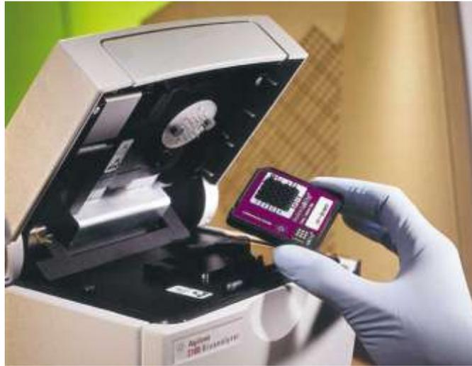
*Figura 3.11: Exemplo de “lab-on-a-chip” para diagnóstico em saúde. Figura extraída de [43].*
