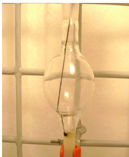
Figura 14 - Transferência da amostra para o topo da coluna cromatográfica
