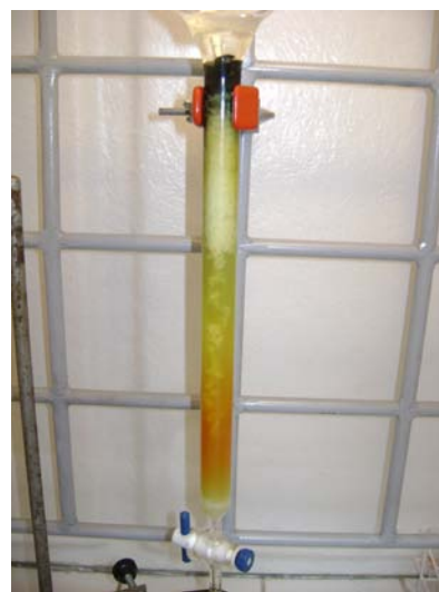
Figura 16 - Fração IV na purificação dos lipídeos na coluna de sílica gel
