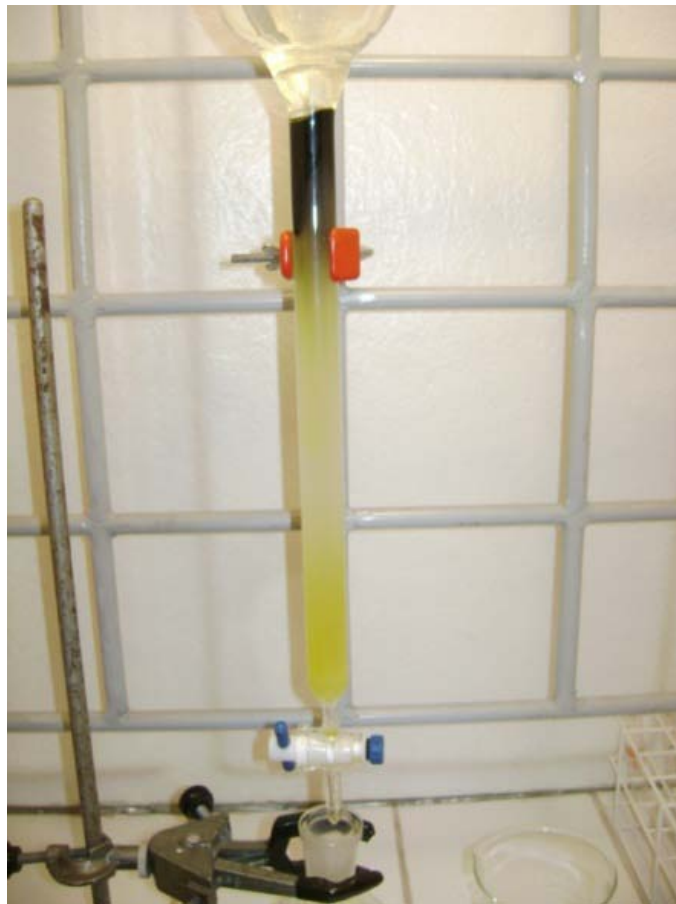
Figura 20 – Purificação com coluna de sílica gel do óleo bruto.
