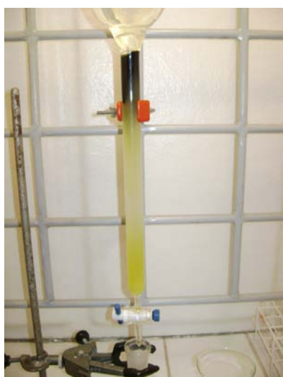
Figura 17 - Fração I na purificação dos lipídeos na coluna de sílica gel
