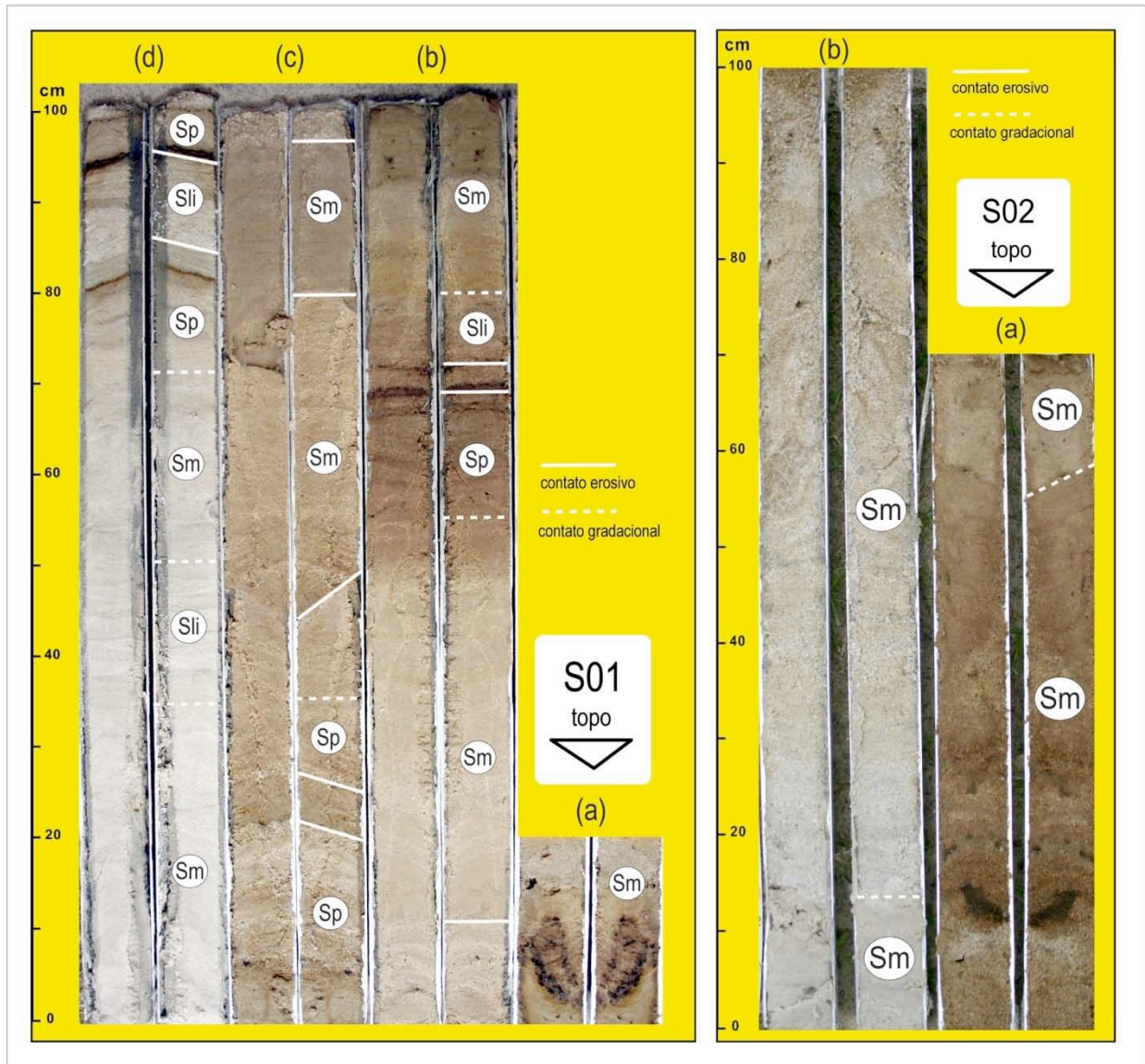
Figura 47: Testemunhos de sondagem S01 e S02, areal das Ilhas III, com as fácies deposicionais indicadas. A altura do segmento de cano de alumínio corresponde a 1 m.
