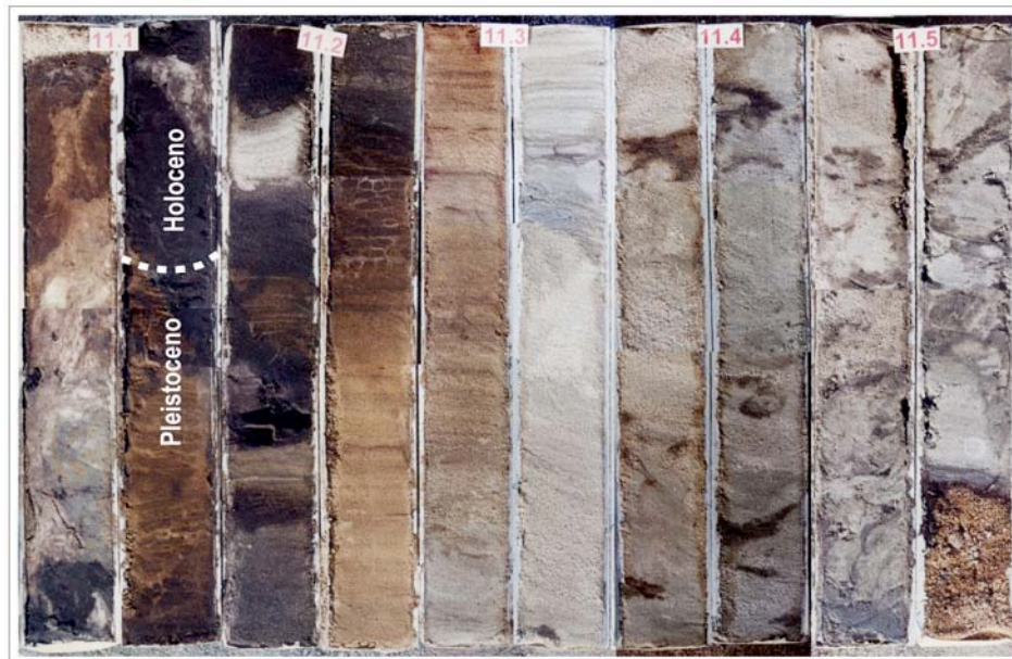
Figura 20: Sondagens por vibrocore n° 11. Sedimentos estuarinos holocênicos em contato com shoreface do Pleistoceno, (Lessa 2000). A altura do segmento de cano de alumínio corresponde a 50 cm.
