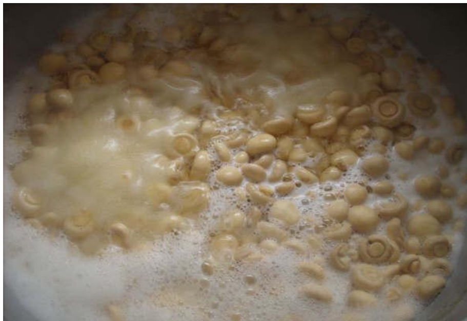
FIGURA 10 – PROCESSO DE INATIVAÇÃO ENZIMÁTICA TÉRMICA DOS CHAMPIGNONS REALIZADO EM UMA DAS INDÚSTRIAS DE CONSERVAS DE CHAMPIGNON DA REGIÃO METROPOLITANA DE CURITIBA – PR, 2009
