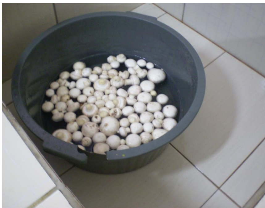
FIGURA 9 – PROCESSO DE IMERSÃO DOS CHAMPIGNONS EM SOLUÇÃO DE 0,4% DE METABISSULFITO DE SÓDIO, REALIZADO POR UMA DAS INDÚSTRIAS DE CONSERVAS DE CHAMPIGNON DA REGIÃO METROPOLITANA DE CURITIBA – PR, 2009
