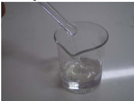
Figura 3.3.1 – Eletrólito polimérico PMMA contendo \text{LiClO}_4 0,5 mol.L -1 em carbonato de propileno.
