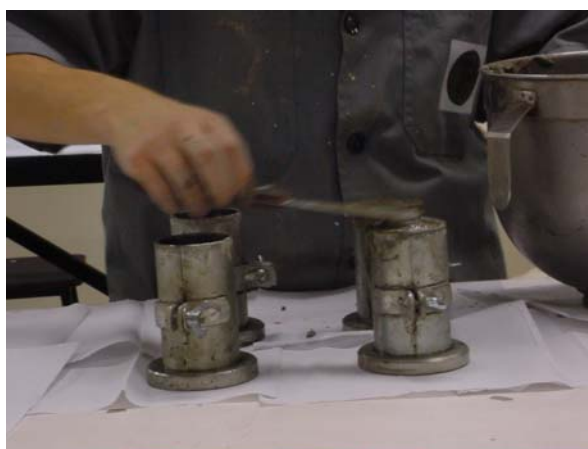
FIGURA 26 – MOLDAGEM DO COMPÓSITO EM CILINDROS METÁLICOS
