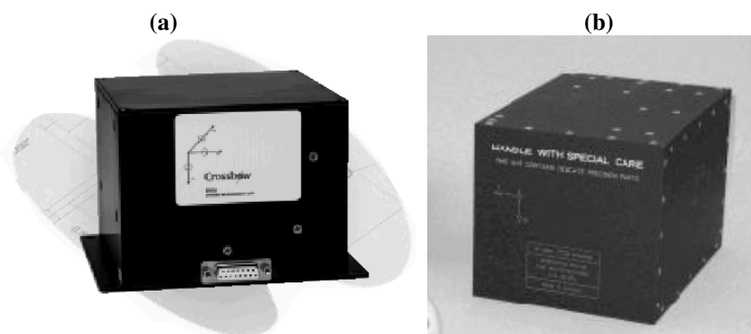
Figura 2.4 - Dois exemplos unidades de medição inercial analíticas:
