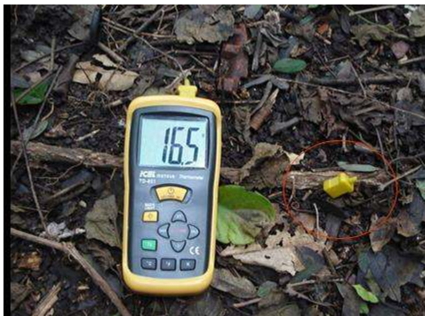
Figura 5. Termômetro utilizado para medição da temperatura do solo e do corpo enterrado. Em destaque o plug do termopar exposto para permitir a medição.
