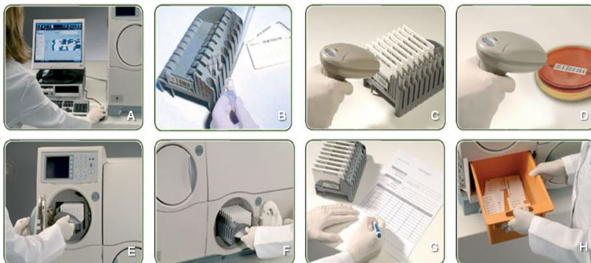
FIGURA 14 – FLUXOGRAMA DE ANÁLISE DAS AMOSTRAS NO SISTEMA AUTOMATIZADO DE IDENTIFICAÇÃO BACTERIANA E ANTIBIOGRAMA VITEK® 2 Compact
