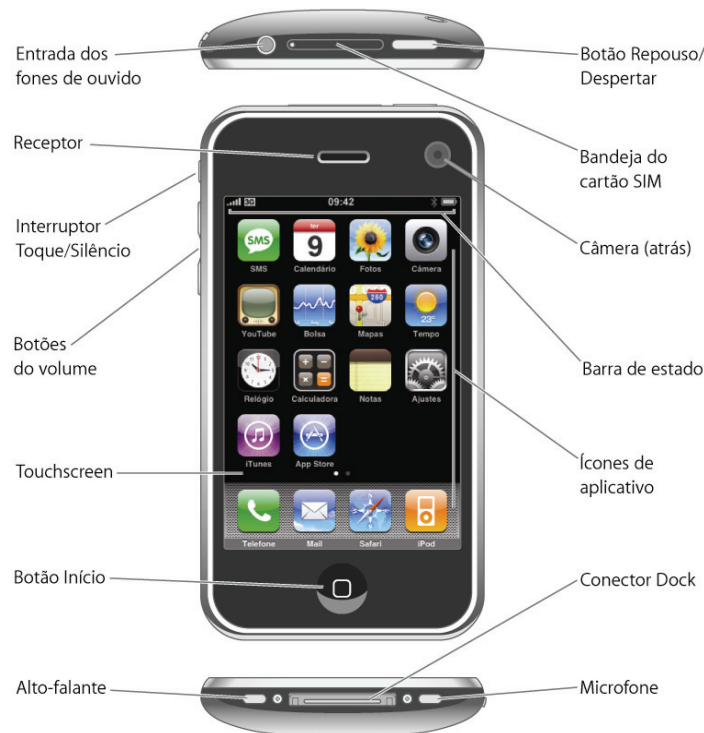
Figura 4: componentes físicos para entrada e saída de dados da interface do iPhone (APPLE, 2008b).
