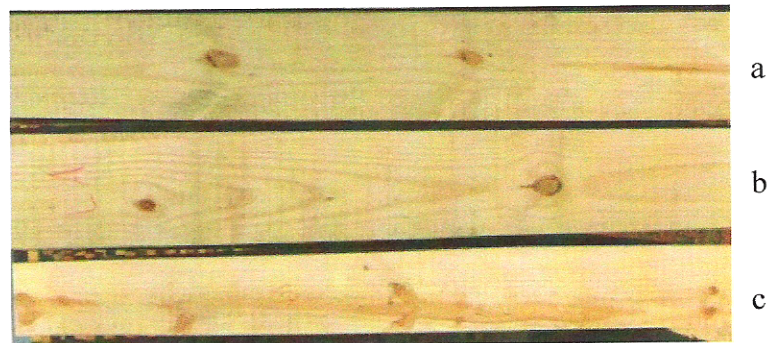
FIGURA 15 - TÁBUAS TRATADAS COM TBTO A 0,000122% E IPBC A 0,125% (a) E TBTO A 0,000122% E IPBC A 0,0625% (b) COMPARADAS COM UMA TÁBUA TRATADA COM A MELHOR RELAÇÃO TESTADA ENTRE OS DOIS PRODUTOS QUÍMICOS (c).
