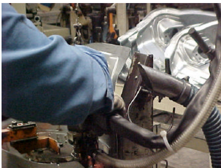
Figura 4.11 – Sistema de Exaustão de Resíduos de Soldagem Ponto
