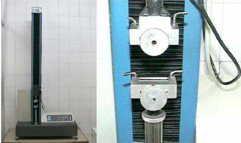
FIGURA 8 – Equipamento universal de ensaio mecânico computadorizado EMIC®, modelo DL500MF.
