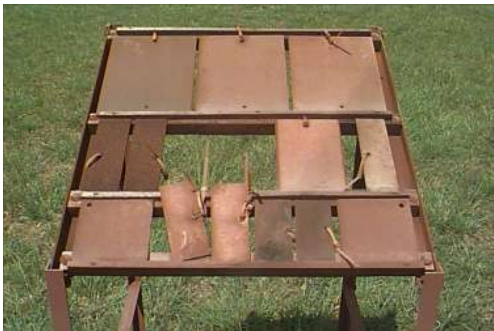
FIGURA 30. ESTAÇÃO DE INTEMPERISMO NATURAL DE ITAQUI- CPS APÓS 18 MESES DE EXPOSIÇÃO.
