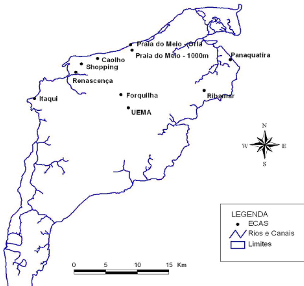
FIGURA 14. REDE DE ESTAÇÕES DE CORROSÃO ATMOSFÉRICA (ECAS) IMPLANTADA NA ILHA DE SÃO LUÍS.
