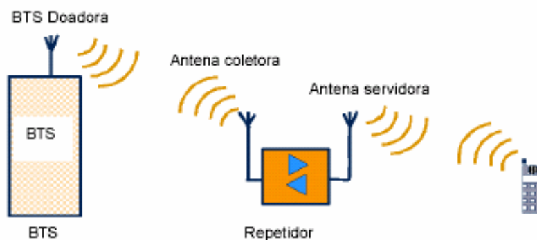
Figura 3.1 - Esquema básico de um sistema com repetidor
