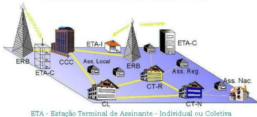
Figura 1.13 – Esquema de um Sistema WLL
