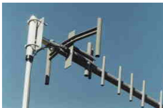
Figura 1.6 – Modelo de Antena para Telefonia Rural via Celular
