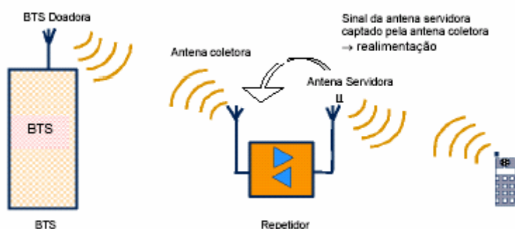
Figura 3.5 - Efeito de realimentação em repetidores
