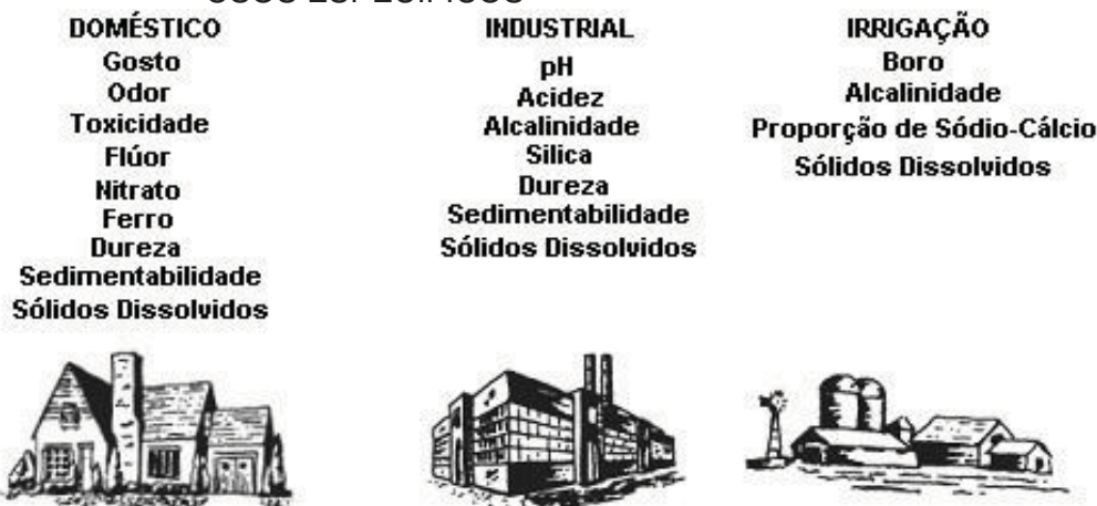
FIGURA 3.13 – PARÂMETROS QUALITATIVOS DA ÁGUA DE CHUVA PARA USOS ESPECÍFICOS
