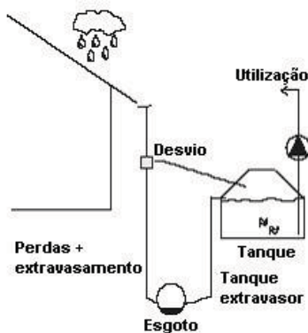
FIGURA 3.18 – SISTEMA DE COLETA DE ÁGUA DE CHUVA DE UM TELHADO
