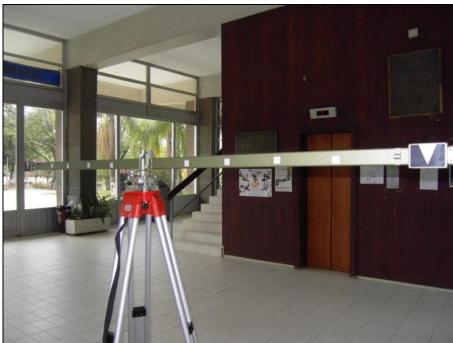
FIGURA 41 – MIRA HORIZONTAL DE ÍNVAR
