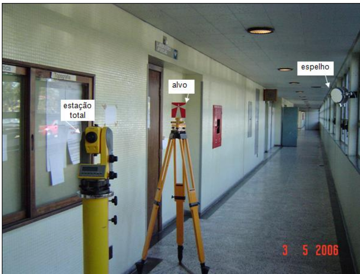
FIGURA 30 – POSICIONAMENTO DO ESPELHO, ESTAÇÃO TOTAL E ALVO NO EXPERIMENTO 1
