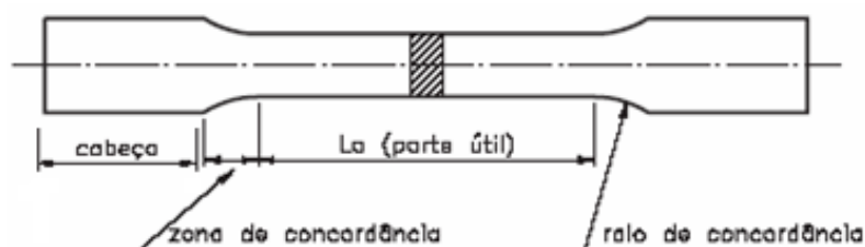
Figura 10 - Ilustração do corpo de prova para o ensaio de tração (CALLISTER, 2003).
