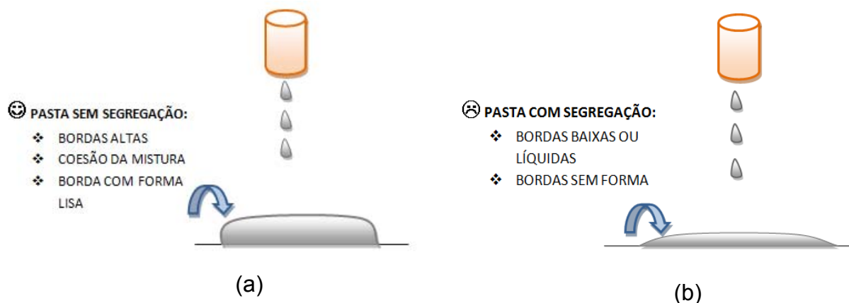
Figura 4.12 – Análise visual da seqüência da pasta escoada. (a) Pasta sem tendência à segregação, (b) Pasta com tendência à segregação
