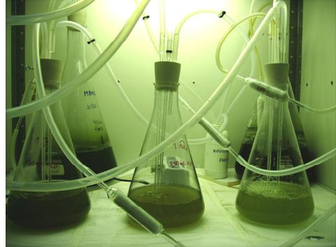
FIGURA 3 - BIORREATOR FECHADO (ERLENMEYERS)
