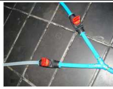
Figura 4.7 - Adaptador em formato de Y utilizado para a injeção de N_2 (mangueira branca) e H_2/H_2S (mangueira azul) no tubo de quartzo.
