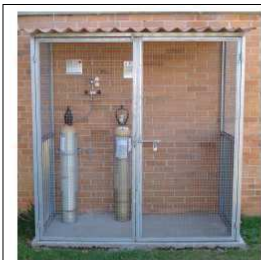
Figura 4.3 - Casa de gases construída para a realização dos testes de sulfetação.
