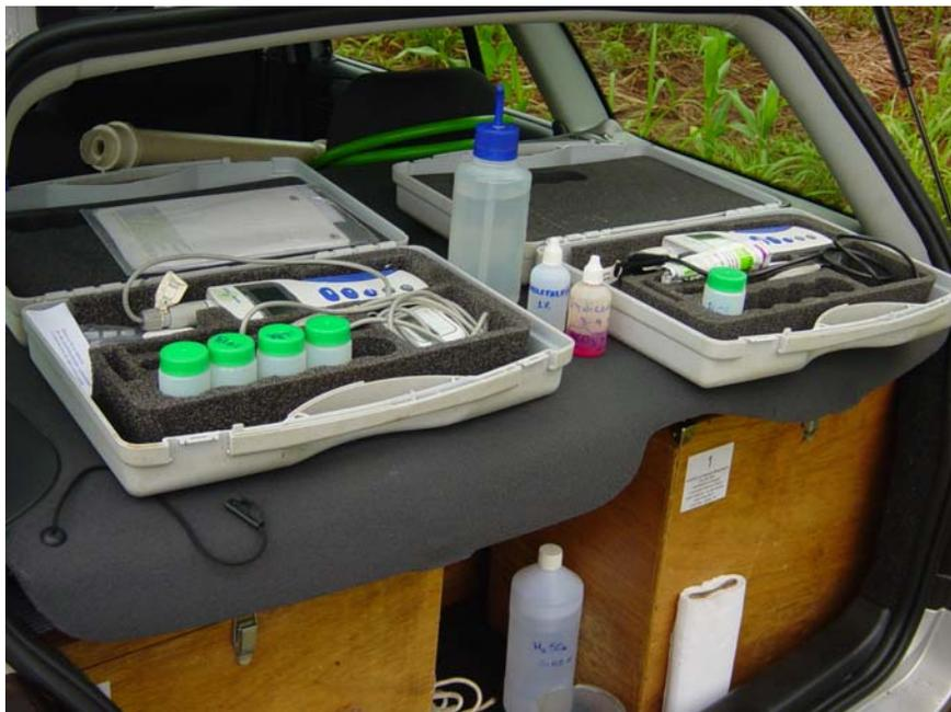
Figura 2 - Materiais utilizados na coleta das amostras (pH e condutímetro portáteis, água deionizada, fenolftaleína, etc)
