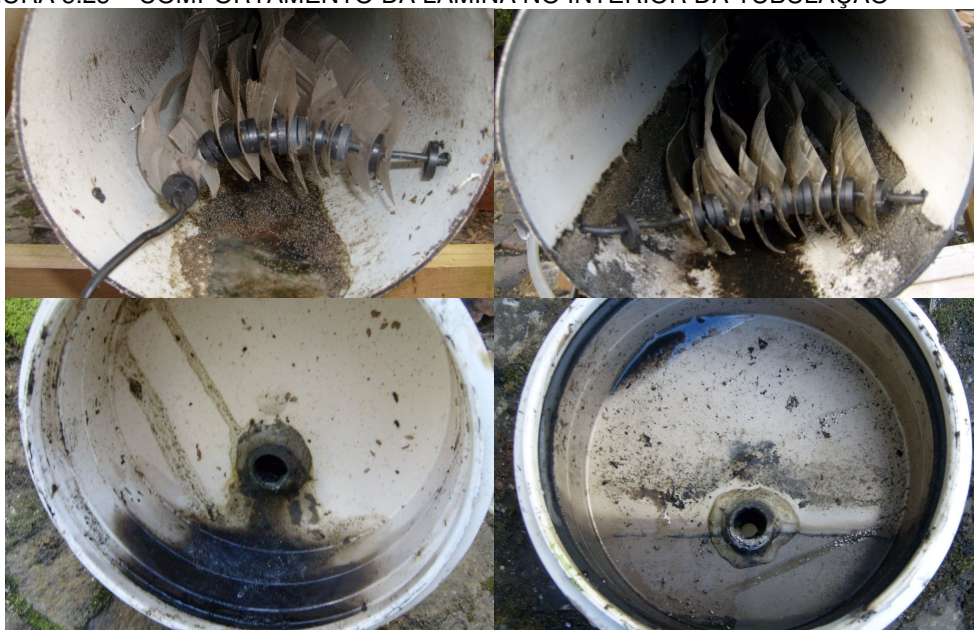
FIGURA 5.25 – COMPORTAMENTO DA LÂMINA NO INTERIOR DA TUBULAÇÃO
