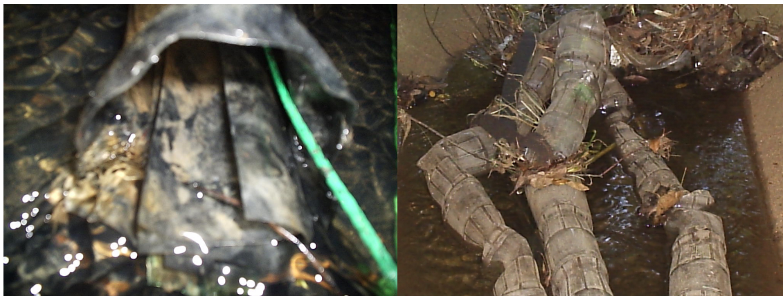
FIGURA 3.10 – FORMAÇÃO DO BIOFILME E GARRAFAS AMASSADAS E OBSTRUÍDAS
