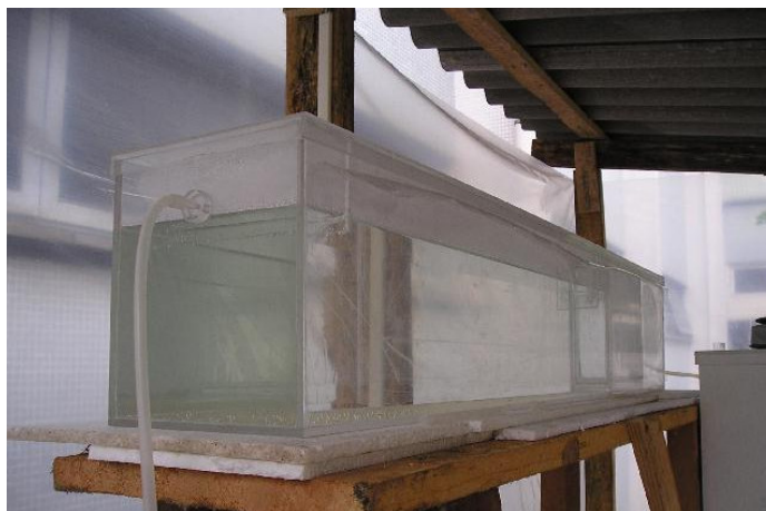
FIGURA 4.2 – TANQUE SÉPTICO EXPERIMENTAL
