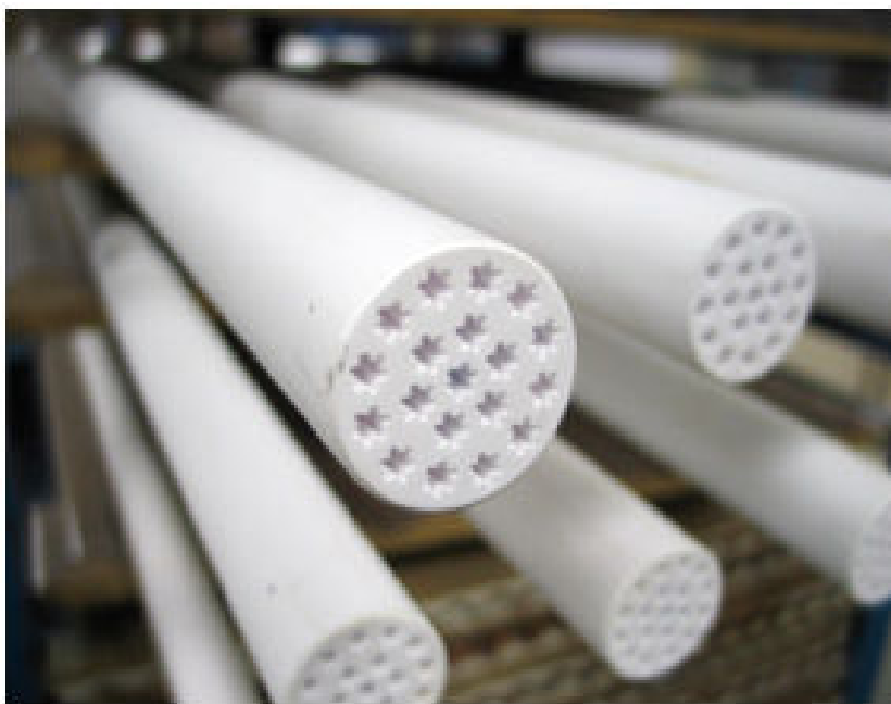
FIGURA 3.1 – MEMBRANA TUBULAR COM CANAIS ESTRELADOS. FONTE: FAIREY INDUSTRIAL CERAMICS, 2008a.
