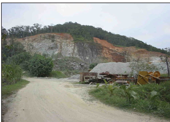
Foto 25 - Pedreira ativa: moagem de rocha migmatítica para brita (BR 277)
