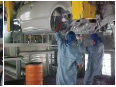
Figura 6-12. Aplicação das “chapelonas” nos veículos (UBS)
