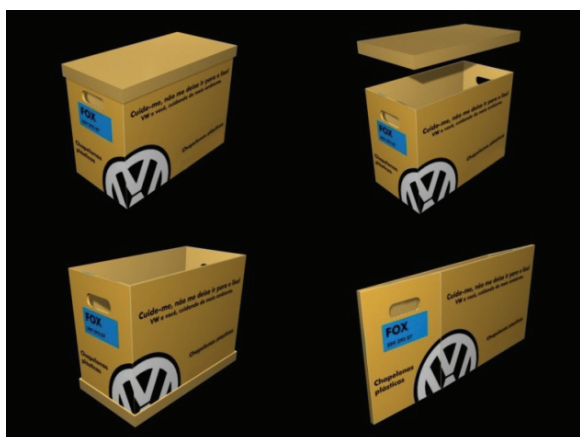
Figura 6-34. Proposta de caixa retornável desmontável em papelão ondulado, individual para cada tipo de chapelona
