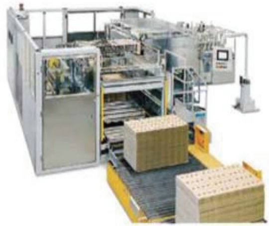
Figura 3-9. Máquina automatizada de produção de embalagens em papelão ondulado com a técnica CFG Fonte: Höerauf (2007)
