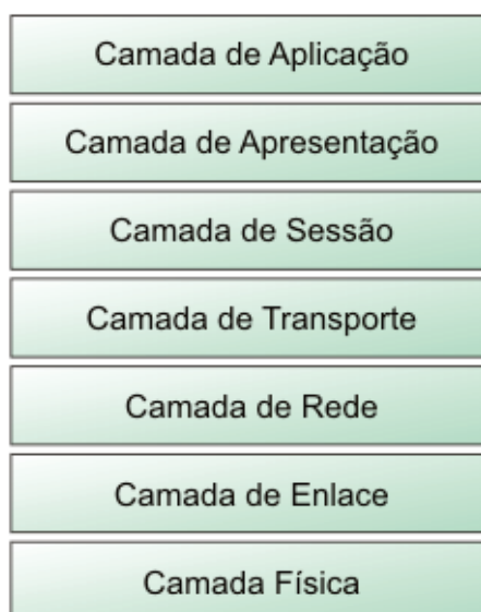
Figura 4 – Camadas do modelo OSI
