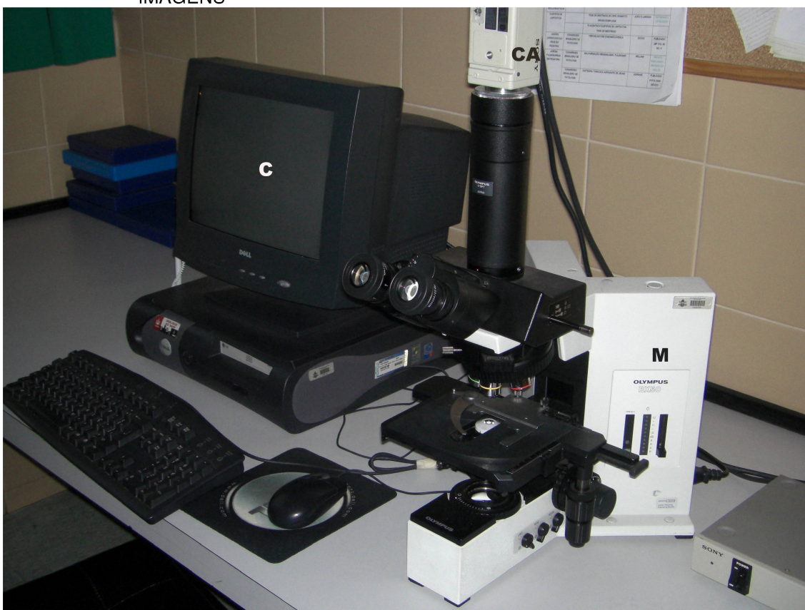
FIGURA 8 - MICROSCÓPIO ACOPLADO AO COMPUTADOR PARA A CAPTURA DAS IMAGENS
