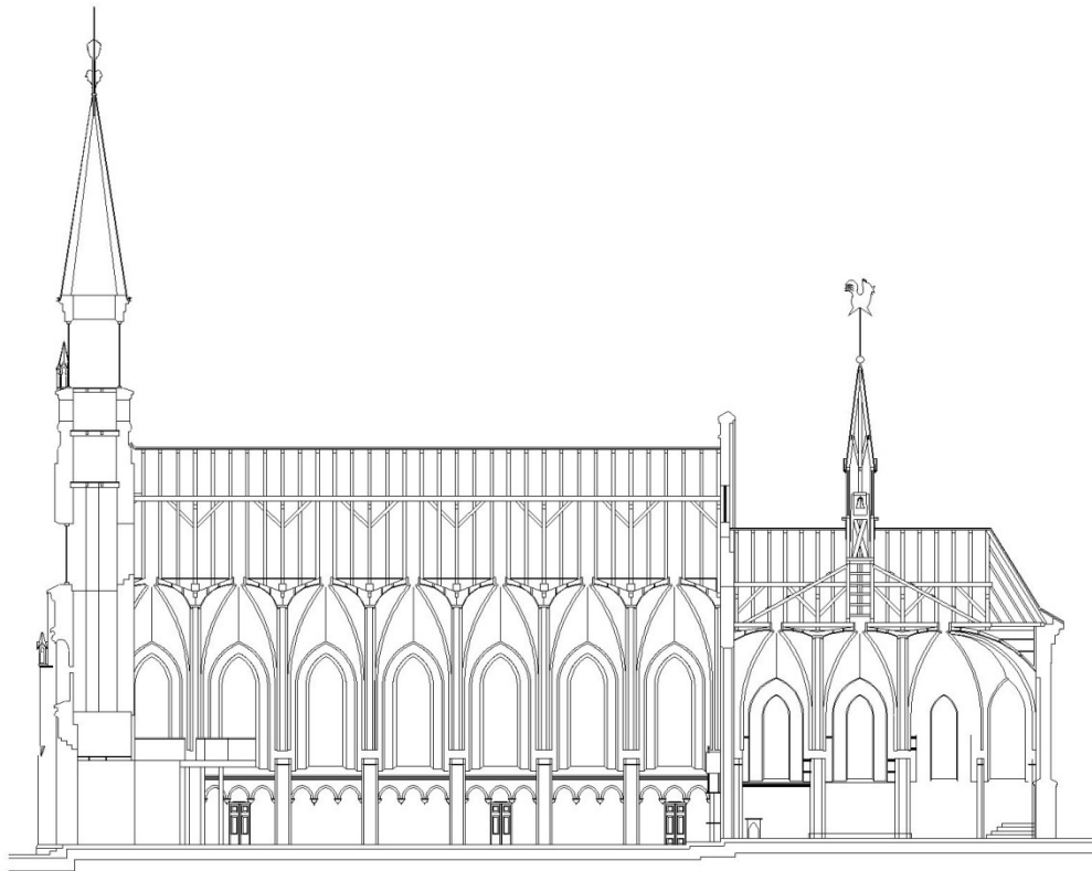
Figura 3.4.3.g: Igreja do Senhor Bom Jesus dos Perdões – croqui: corte longitudinal do edifício.
