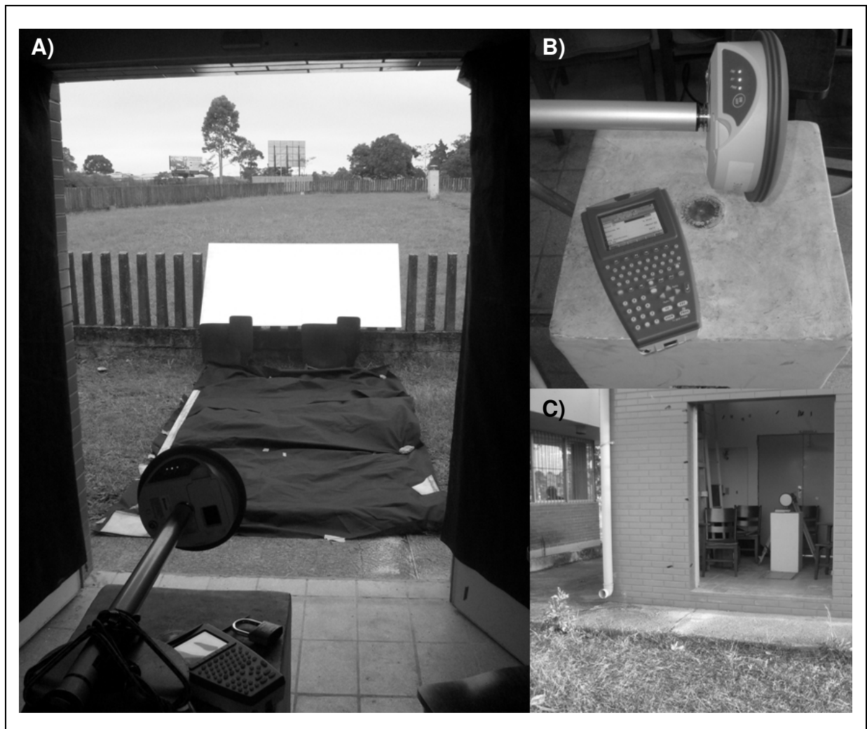
FIGURA 31 – VERIFICAÇÃO DA REFLEXÃO DE MULTICAMINHO EM AMBIENTE INTERNO UTILIZANDO A ETAPA 3. A) VISTA DOS REFLETORES LOCALIZADOS NA PARTE EXTERNA. B) ANTENA SOBRE O MARCO. C) VISTA DA ANTENA LOCALIZADA NO INTERIOR DO OBSERVATÓRIO.
