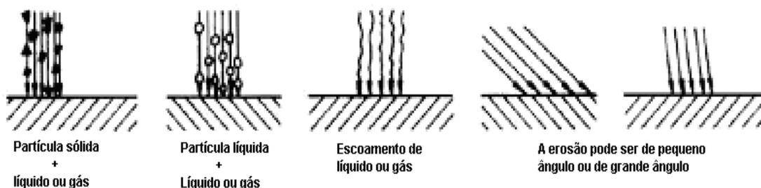
FIGURA 9 - REPRESENTAÇÃO ESQUEMÁTICA DO PROCESSO DE EROSIÃO [1]. FONTE: PMT 2100 - INTRODUÇÃO À CIÊNCIA DOS MATERIAIS PARA ENGENHARIA (2005).
