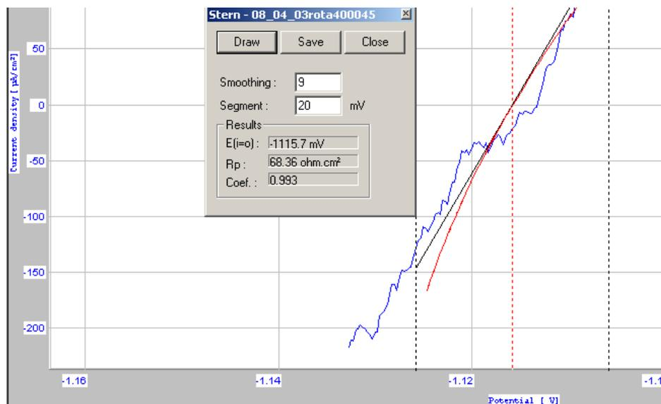
FIGURA 40 - RESISTÊNCIA DE POLARIZAÇÃO LINEAR (RPL)  $\pm 20\text{mV}$  EM RELAÇÃO AO  $E_{i=0}$ , A  $1\text{mV}\cdot\text{s}^{-1}$ , 400rpm, LIXA COM GRANULOMETRIA 1200, SEM ALUMINA.
