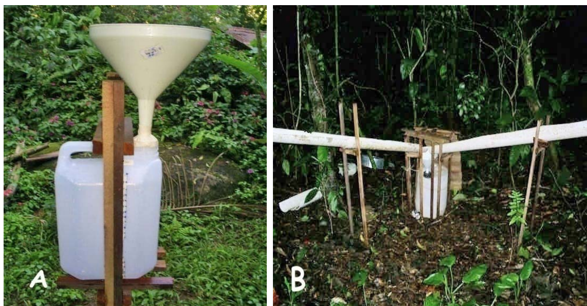
FIGURA 3 – INSTALAÇÃO DOS PLUVIÔMETROS
