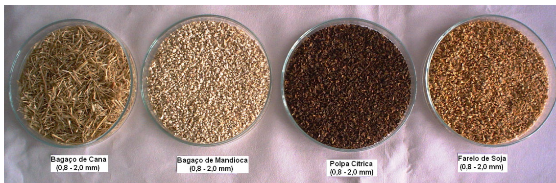
FIGURA 5. Resíduos e subprodutos agroindustriais utilizados, na granulometria de 0,8-2,0mm: Bagaçõ de Cana-de-Açúcar, Bagaçõ de Mandioca, Polpa Cítrica, Farelo de Soja.
