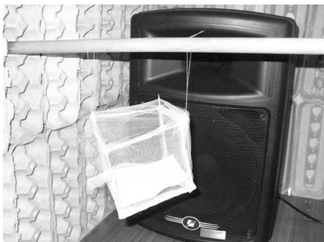
Figura 13 – Montagem do experimento de sensibilidade às frequências
