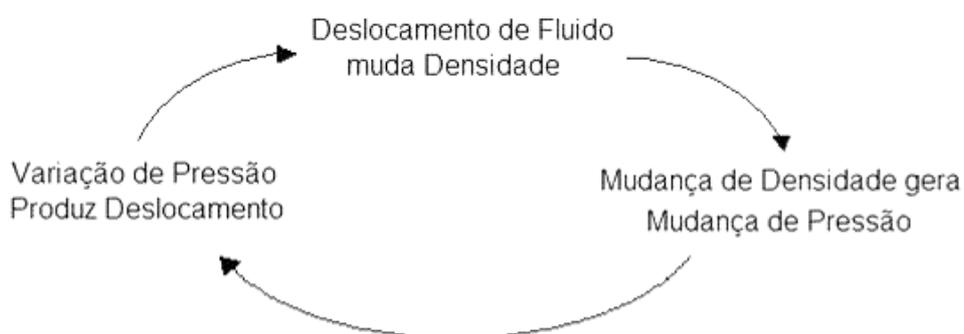
Figura 1 - Mecanismo dinâmico de propagação do som.
