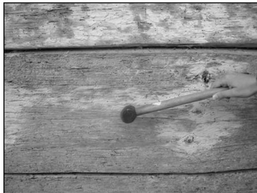
FIGURA 38 – MÉTODO DE PERCUSSÃO POR MEIO DE MARTELO DE BORRACHA
