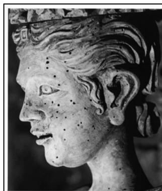
FIGURA 17 – ESTÁTUA DE MADEIRA DETERIORADA POR ANOBÍDEO (BROCA-DE-MADEIRA)
