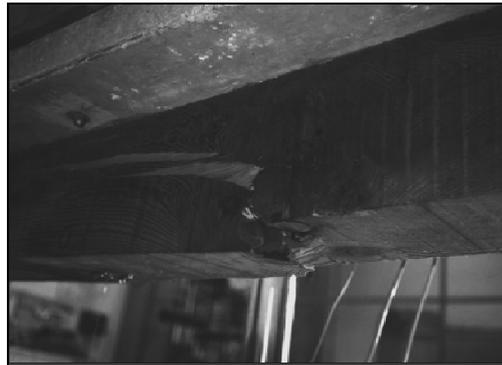
FIGURA 19 – RUPTURA DE VIGA DE MADEIRA POR FLEXÃO
