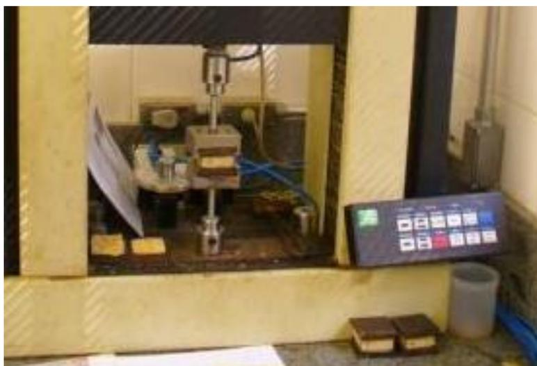
Figura 68. Máquina universal de testes, com dispositivo para medição de resistência à tração interna de aglomerados.
