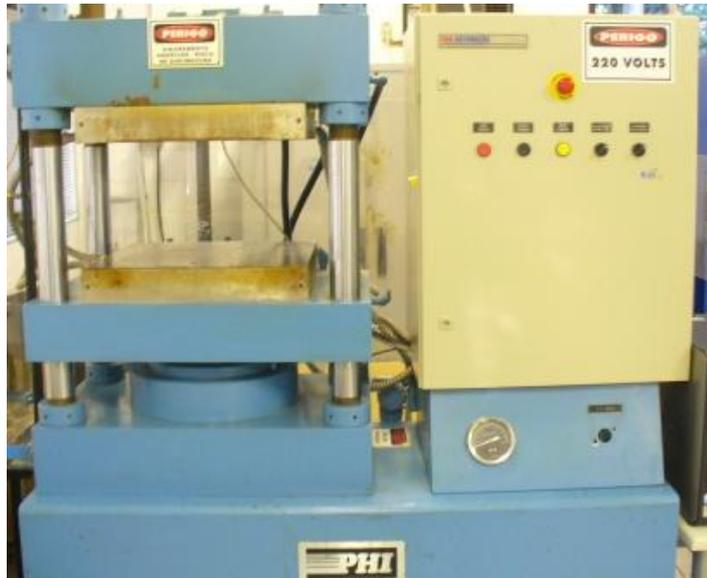
Figura 66. Prensa de laboratório.
