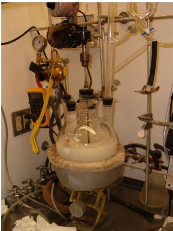
Figura 62. Balão-reator e acessórios para a síntese de resinas. (foto do autor)
