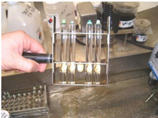
Figura 63. Tubos Gardner-Holdt para medição de viscosidade.
