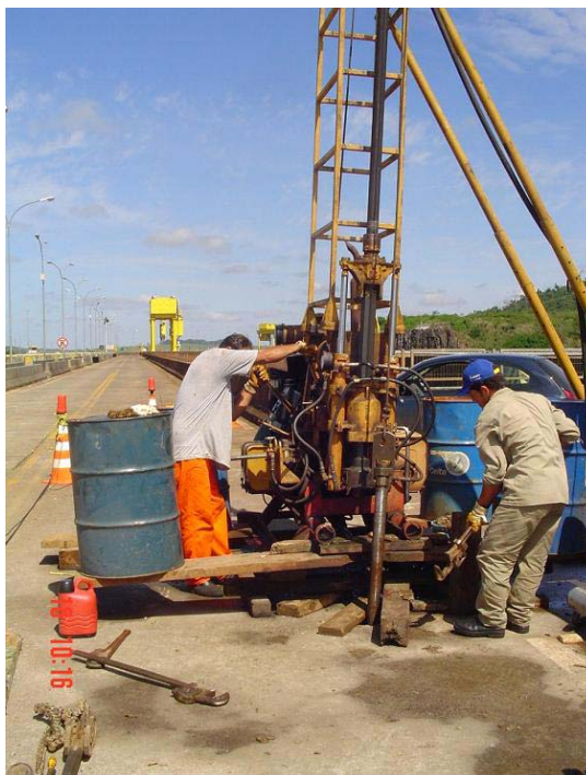
Figura 17 – Extração das amostras de CCR da barragem de Salto Caxias (Fonte: LACTEC, 2006)
