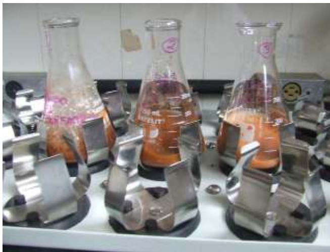
FIGURA 12. Aparelhagem utilizada em estudos de remediação de solos contaminados por processos de soil-washing .
