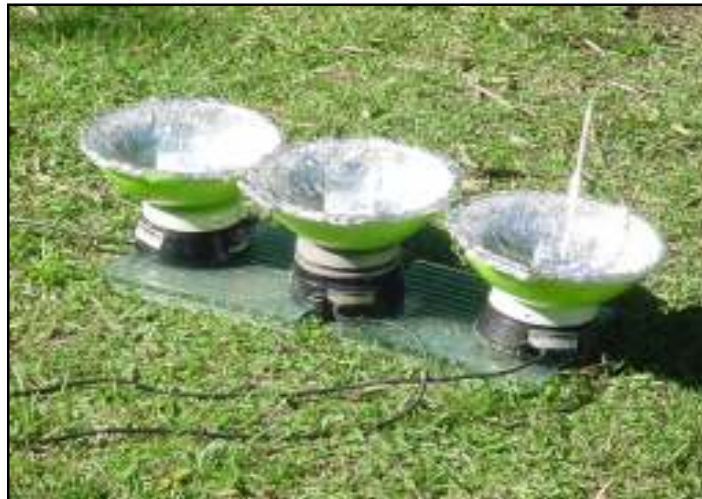
FIGURA 15. Fotografia dos reatores fotoquímicos operados com radiação solar.
